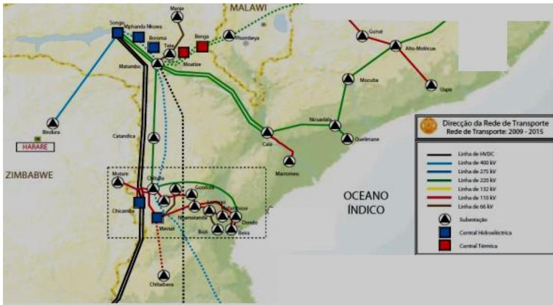
Figura 1 Configuração da rede de transmissão na região centro de Moçambique (EDM, 2010).
